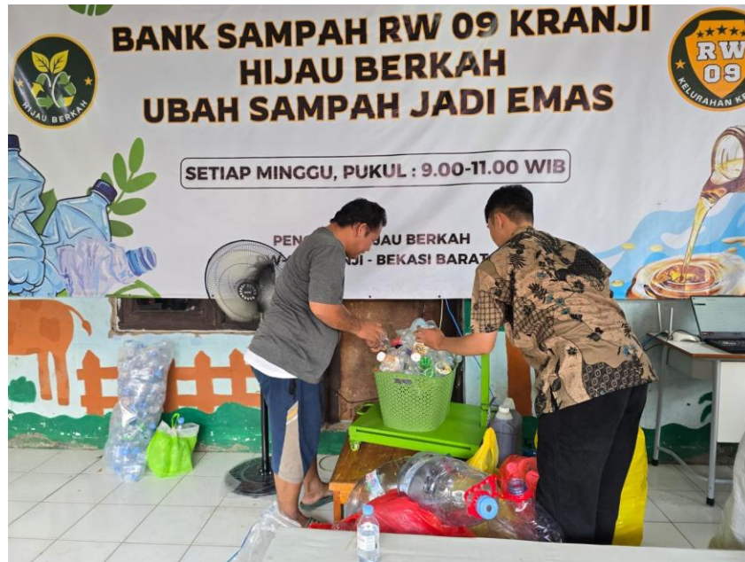
Gambar 2. Proses uji coba dan penggunaan alat timbangan IoT untuk menimbang sampah plastik, terintegrasi dengan sistem yang dioperasikan melalui laptop.
